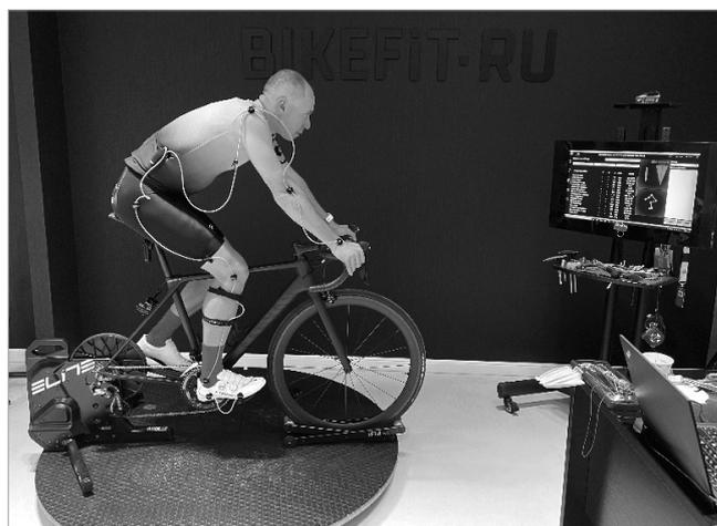
**Рис. 3.** Процедура видеонализа с использованием технологии захвата движения
