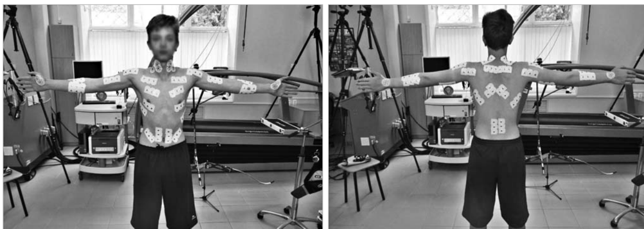
Рис. 1. Общий вид наложения электродов для отведения ЭМГ
