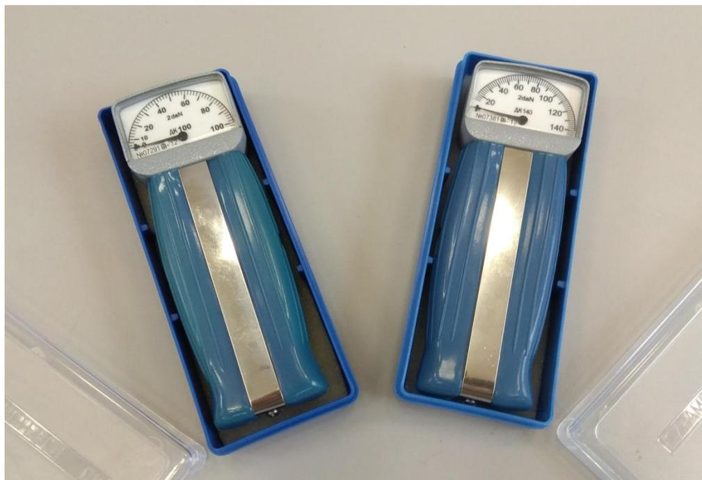
Рисунок - 2. Механические кистевые динамометры ДК-100 и ДК-140
