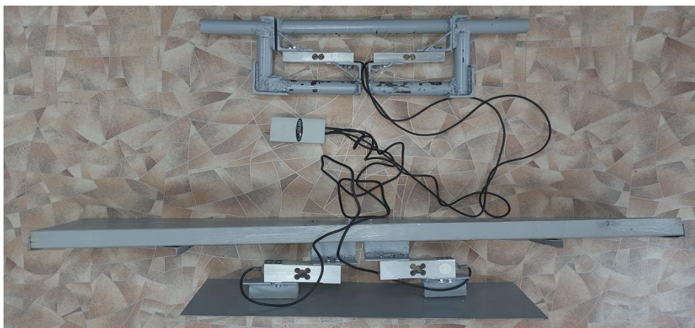
Рисунок 42. Обобщенный вид устройства для фиксации и передачи данных усилия тяги мас-рестлера
