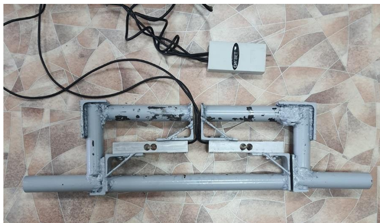
Рисунок 15. Фото конструкции палки перетягивания с тензометрическими датчиками и устройством передачи данных на электронные устройства
