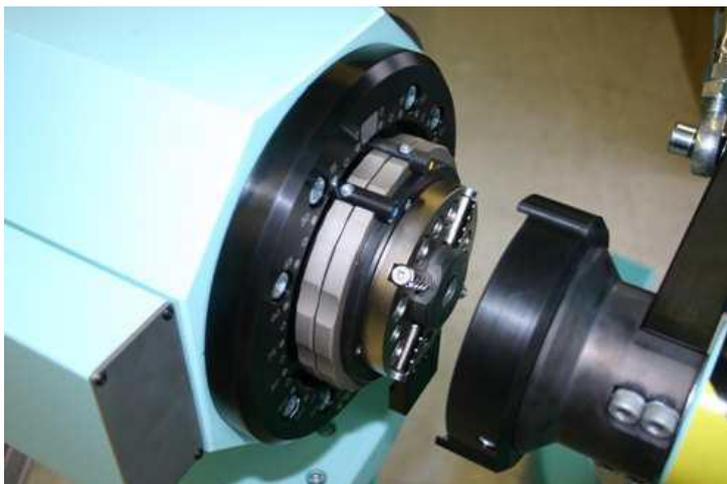
Рисунок 8. Динамометр модулей TP и MJ
