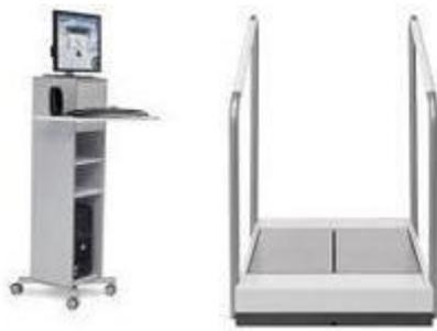
Рисунок 15- Тензометрическая силовая платформа КОБС
