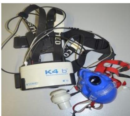
Рисунок 3 – Портативный газоанализатор «K4b<sup>2</sup>».
