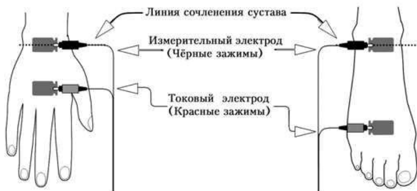
Рисунок 1 – Расположение электродов биоимпедансного анализатора на руке и ноге
