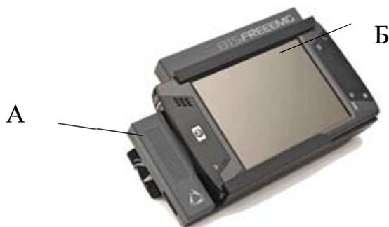
Рисунок 21 – А – Приемник данных; Б – КПК HP iPAQ hx4700
