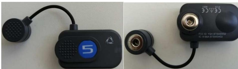
Рисунок 19 – Беспроводной датчик ЭМГ системы BTS FREEEMG (вид сверху и снизу)
