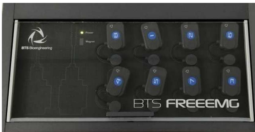
Рисунок 22 – Зарядное устройство для датчиков ЭМГ
