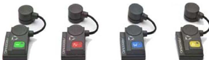
Рисунок 20 – Беспроводные датчики ЭМГ системы BTS FREEEMG
